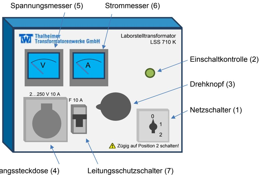
Zum Anschluss des Laborsparstelltransformators LSS 710 muss das Netzkabel mit einer ordnungsgemäß installierten Schutzkontaktsteckdose verbunden werden.
